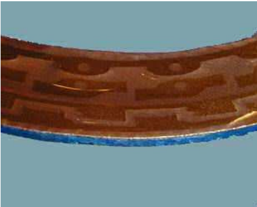
Platine während dem Ätzvorgang, rechts eine "spröde" Platine
